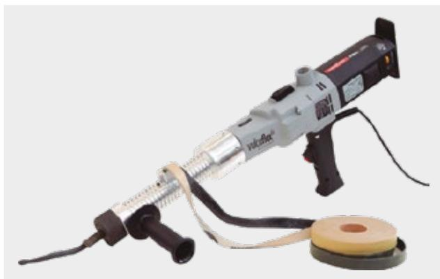
Se la utiliza para aplicar los compuestos VFT-P y VFT-B en diversas superficies de caucho.
